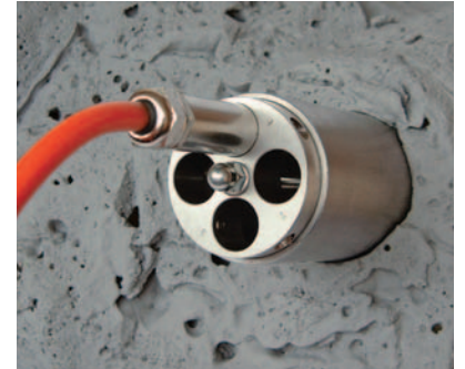
RMT4; 4 Stangen mit elektrischen Weggebern für automatische Messung
