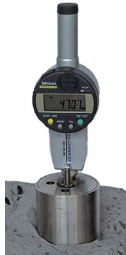
RM3; 3 Stangen mit Setzdeflektometer für manuelle Messung
