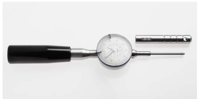
RDM50 mit 50 mm Messbereich und analoger Anzeige
